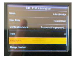
10. Seleccionar la huella dactilar a capturar mediante los botones de navegación
